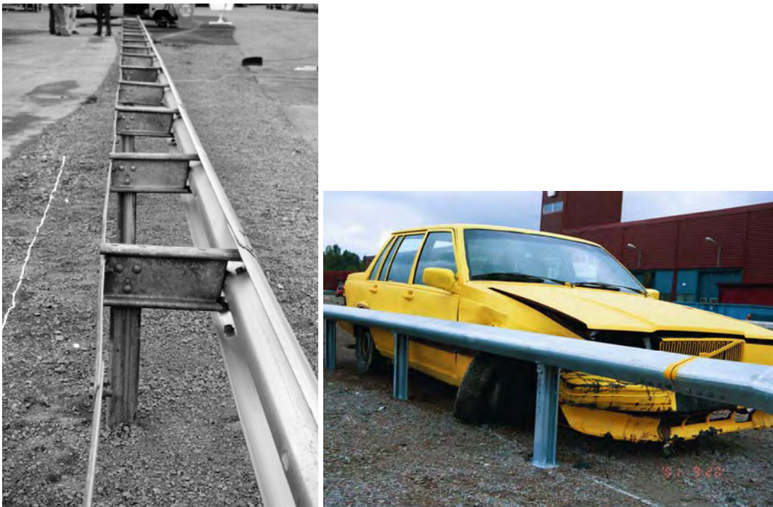
Figur 3 W-balk med tvärrarm, EM 1,33, samt ett ellipsräcke från AB Varmförzinkning.
