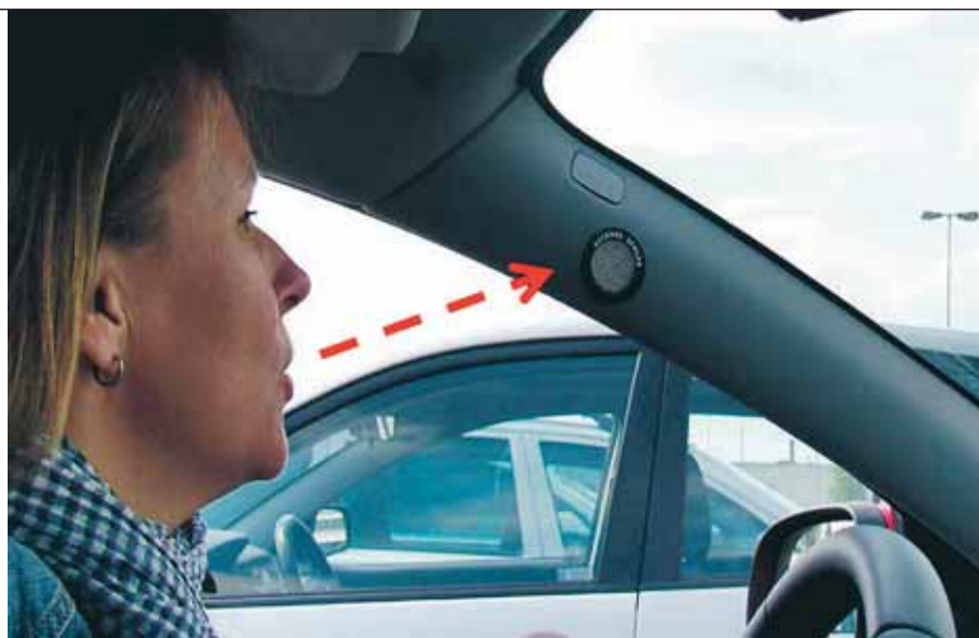
Beröringsfri alkoholmätning genom riktad utandning mot sensor integrerad i bilens A-stolpe. Foto: Autoliv
