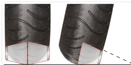
fig. 2 Hjulets omkrets är mindre vid däckets kant. Framgaffelns geometri och däckets runda profil gör att en motorcykel automatiskt svänger när den lutas.
