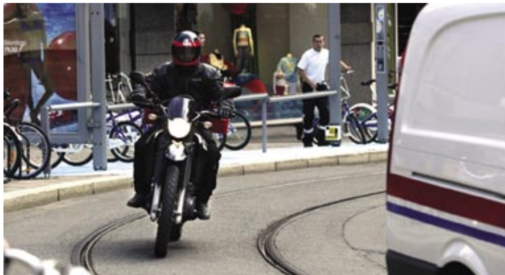
Trikkeskinner: Når det regner er det lurt å krysse trikkeskinner mest mulig "på tvers".
