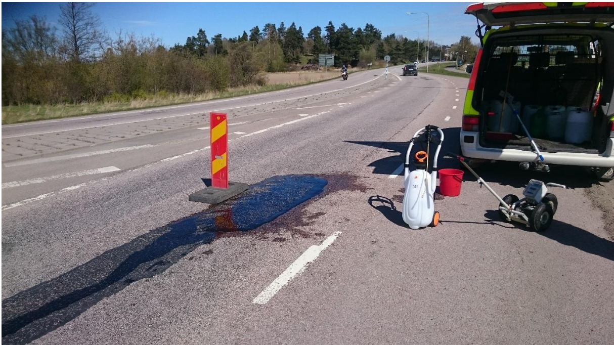
Figur 12. Mätning med PFT på en snabellagning i våt-betingelse.
