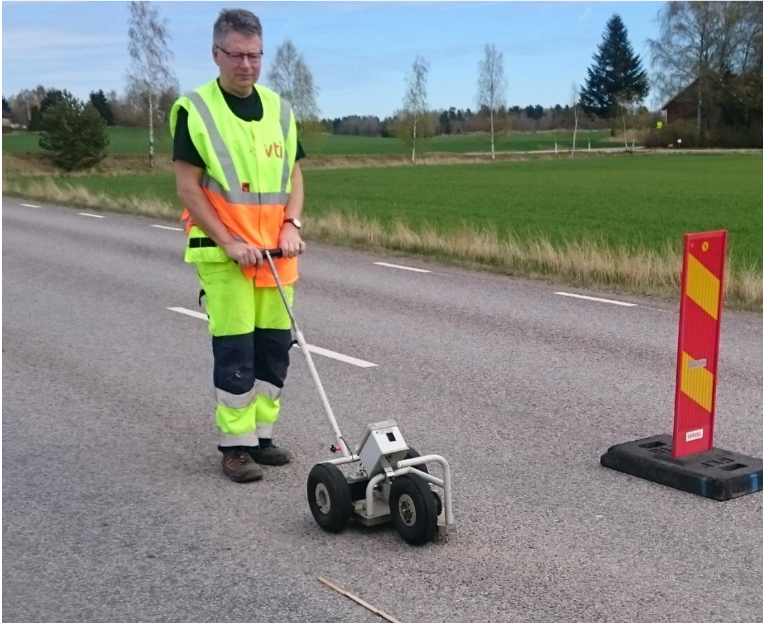
Figur 10. PFT används på vägbeläggning som har en grov ytstruktur. Asfalten är torr på fotot.
