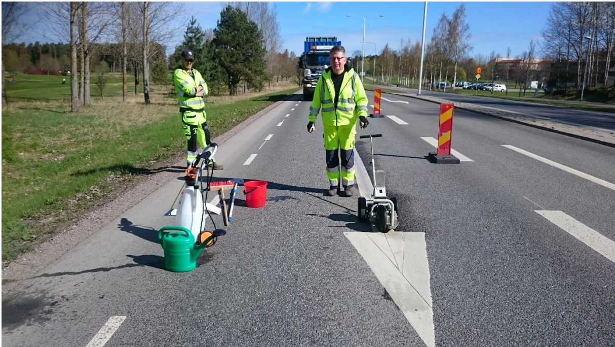
Figur 11. Mätning med PFT på linjemarkeringar.
