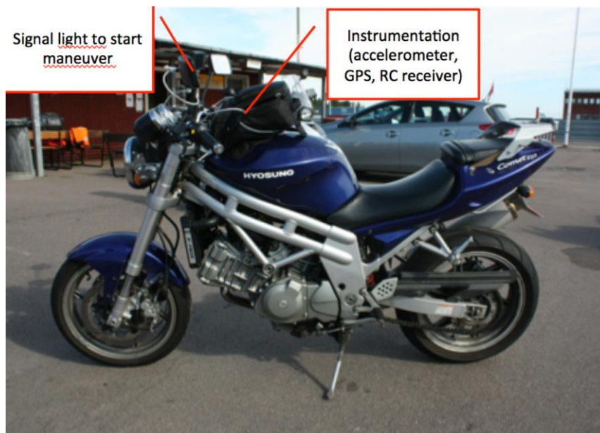
Figur 12: Provutrustning - Mätssystem och montering på MC
