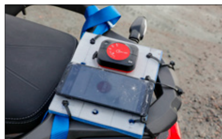
Ovan vänster: Dual Skypro XGPS160 samt mobil med RaceChrono Pro monterat på en av hojarna. Ovan höger: Mätdata analyseras med stort intresse i Racelogic VBOX Test Suite.
