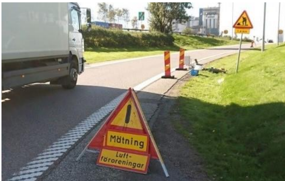
Figur 8. Exempel på mätplats för vägkantsmätning med RSD 5000-instrument.
