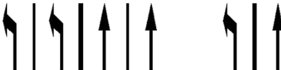
Figur 12.2.1.3-1 Exempel körfältslinje i tillfart till korsning
