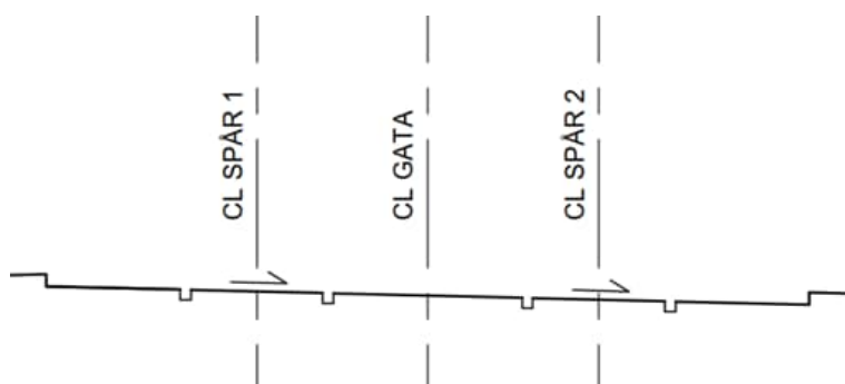
Figur 8.1.6.6.2-2 Typsektion för spårväg i blandtrafik i fullt utbildad kurva (rälsförhöjning och skevning)
