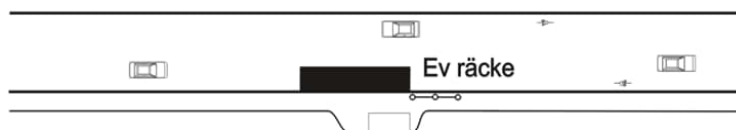
Figur 10.1.4.5-1 Utformning av körbانهållplats i tätortsmiljö
