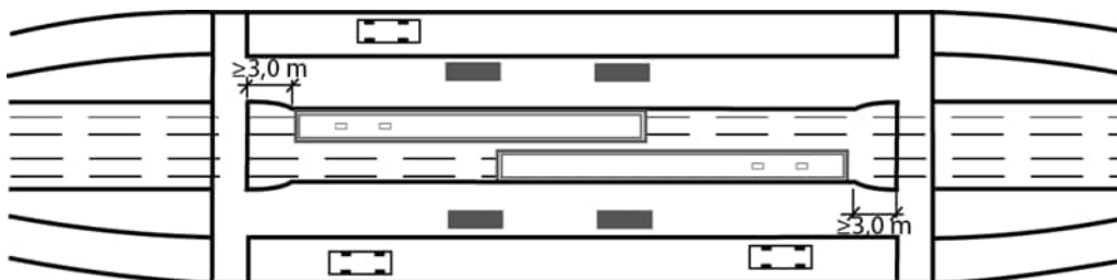
Figur 10.2.3-2 Principskiss över hållplats med parallella hållplatslägen
