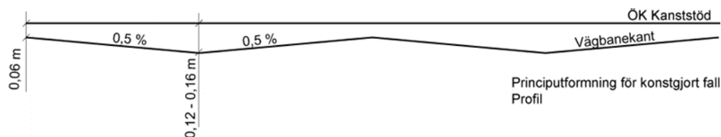
Figur 8.1.6.9-1 Konstgjort fall (svackfall)
