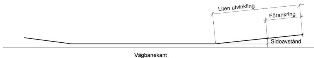
Figur 6.3.6.3-1 Räckesavslutning med liten utvinkling
