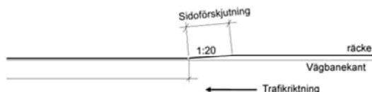
Figur 6.3.3.9-1 Sidoförskjutning av räcke
