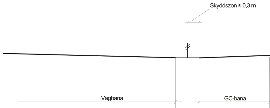
Figur 6.2.2.1-3 Skyddszone mot räcke
