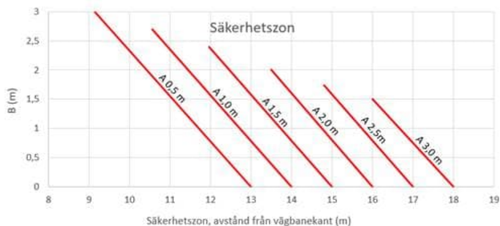
Figur 6.1.3.5-2 Säkerhetszonens bredd (VR 110 km/h)
