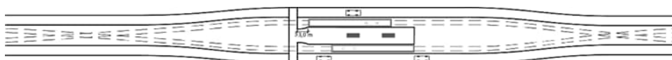
Figur 10.2.3.3-4 Hållplats på gata med mittplattform (vänstertrafik vid hållplatsläget, för trafik med spårvagnar med dörrar enbart på höger sida)
