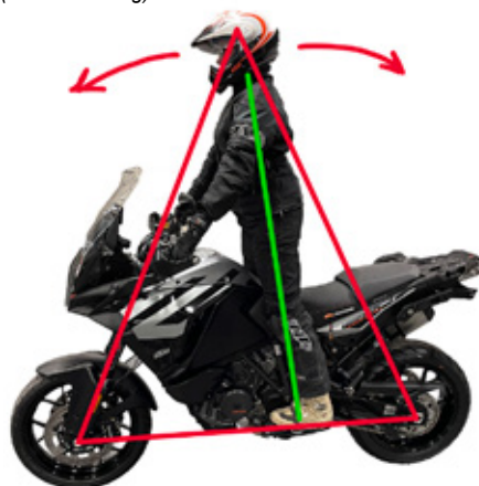
Så kallad "mastställning" där triangeln blir hög och smal, dvs den svajar och är instabil. Kör man på ett hinder så kan man kastas över styret. Kroppen är nästan spikrak (grön markering) vilket gör att speciellt långa förare inte når styret och man kompenserar då med styrhjäjare, helt i onödan.
