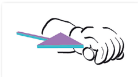
Motstyrning. Skall du svänga åt höger, ger du styret ett litet tryck på höger handtag.
