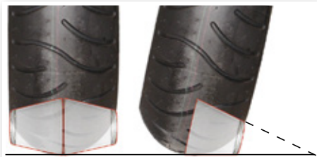
fig. 2 Hjulets omkrets är mindre vid däckets kant. Framgaffelns geometri och däckets runda profil gör att en motorcykel automatiskt svänger när den lutar.
