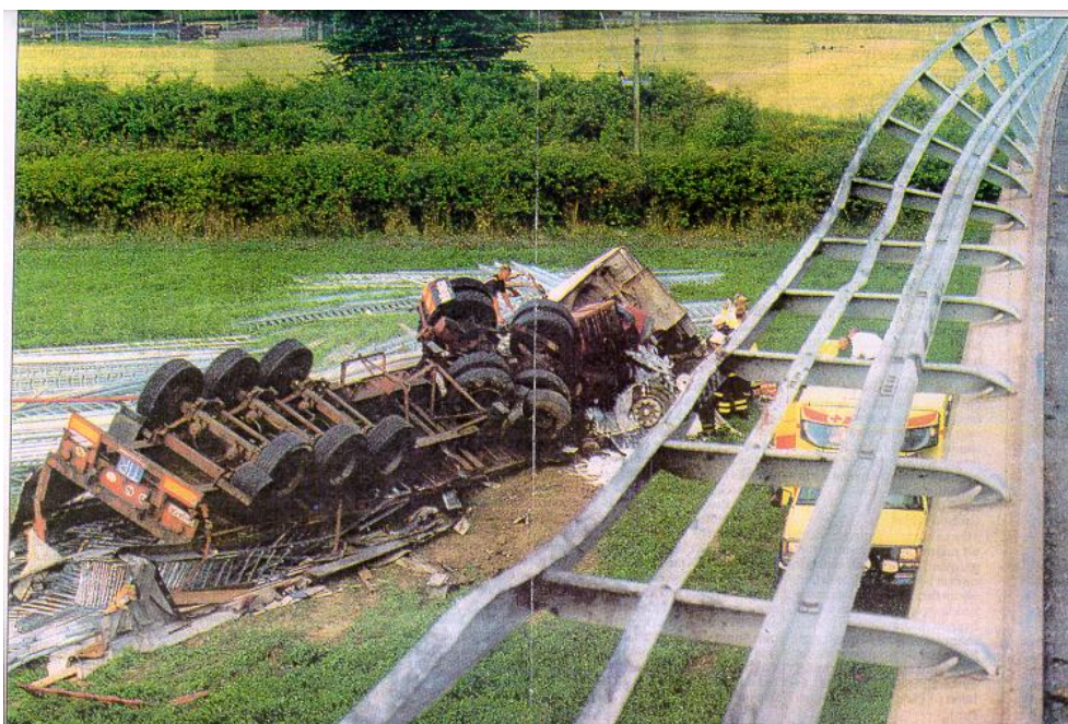
Figur 8-A Olyckskonsekvens för lastbil som kört på för svagt räcke
