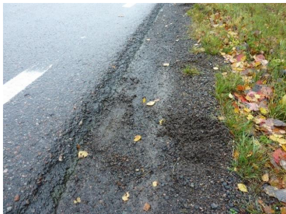
Figur 38. "klack-/sparkprov" av styvhet och stabilitet av stödremsa.
