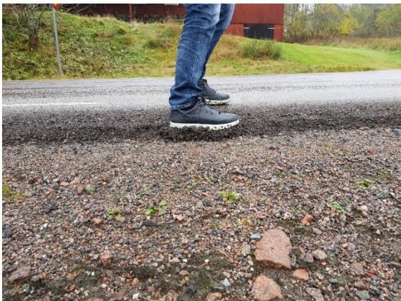
Figur 38. "klack-/sparkprov" av styvhet och stabilitet av stödremsa.
