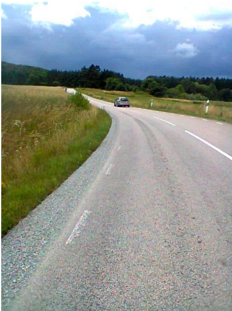
Figur 10. Mycket löst grus på vägbanan. (Foto: SMC)
